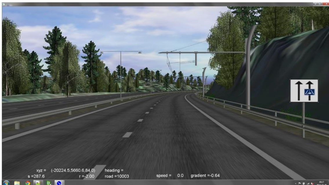
Figur 4. Elväg med luftledningar i VTI:s simulator, från projektet “Demonstration av elektrifierade fordon och vägar i körsimulator” finansierat av Energimyndigheten. (Bild: VTI/ skärmdump från simulering.)
